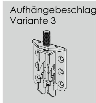
Die Aufhängewinkel entsprechend den vormontierten Aufhängebeschlägen (auf der Rückseite des Möbels) an die Zimmerwand montieren
